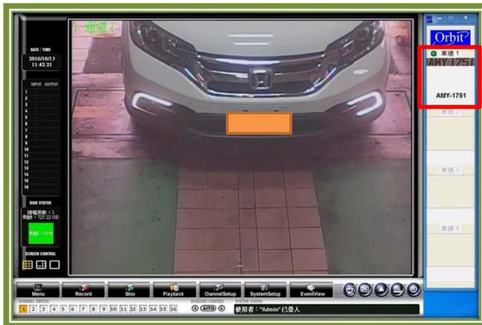
圖 4-4 車牌辨識系統拍照後進行車牌分析
